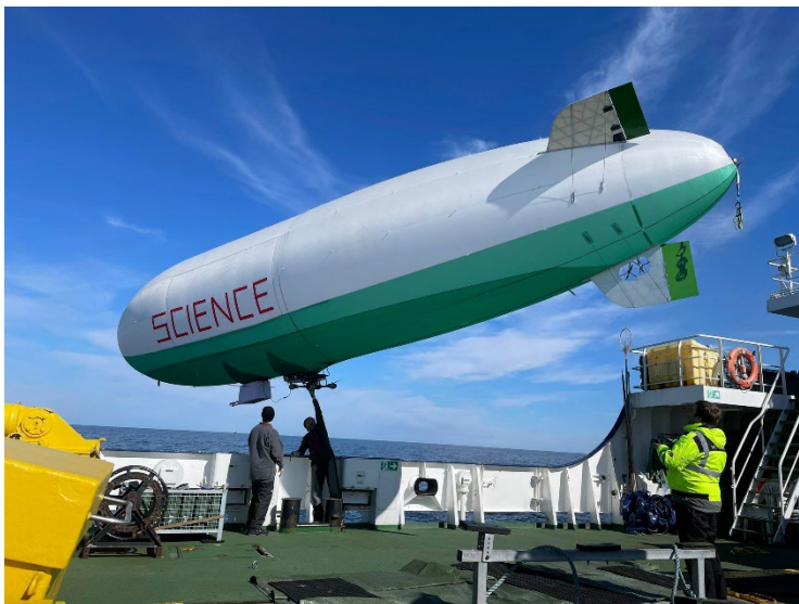
Bilder: Mit Aerosolmesstechnik bestücktes 12 m langes Luftschiff der Karlsuniversität Prag, um ausgewählte Partikeleigenschaften direkt in den Abgasfahnen von Schiffen zu messen
